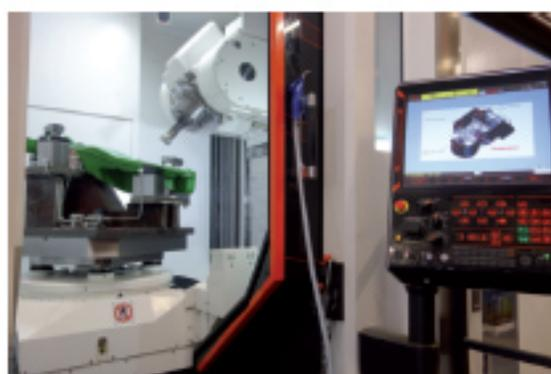
Un bel exemple de pièce pour chargeur et tracteur John Deere sur son système de bridage spécifique fabriqué par MBP.
